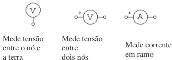
Figura 2 : tipos de pontas de prova (probes)
