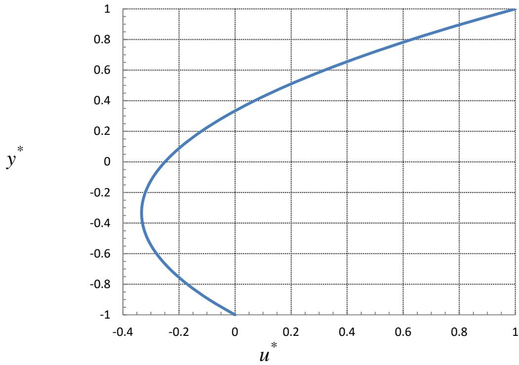
A máxima velocidade para a esquerda é calculada da condição de extremo local  $\frac{du^*}{dy^*} = 0$ , resultando  $y^* = -\frac{1}{3}$  e
