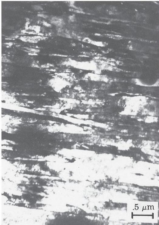
Estrutura da **martensita em plaquetas** em uma liga Fe-0,2% C. (Note-se o alinhamento paralelo das plaquetas).
