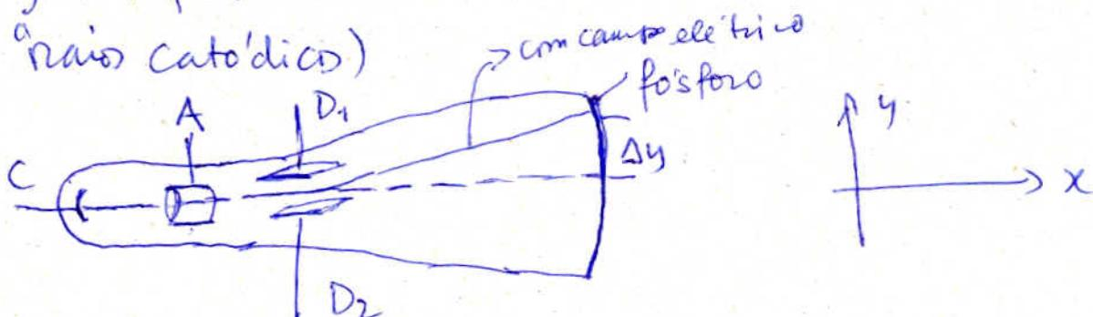
Se as placas de defletores D<sub>1</sub> e D<sub>2</sub> estiverem no mesmo potencial, o feixe de raios catódicos segue em linha reta, até atingir a parede revestida internamente com um material fosforescente, produzindo um ponto luminoso (como numa tela de TV de tubo).
