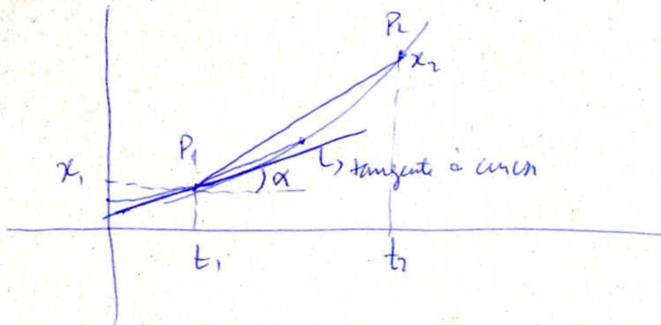
Portanto: a derivada  $\frac{dx}{dt}$  em  $t = t_1$  corresponde à inclinação da reta tangente:
