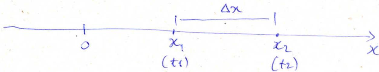
Note que  $\Delta x$  será  $> 0$  se  $x_2 > x_1$ , e negativo se  $x_2 < x_1$  (ou  $x_2$  à esquerda de  $x_1$ , para um eixo orientado para a direita, como o da figura).
