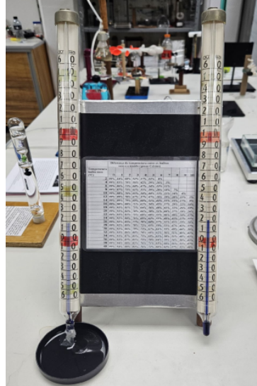
Figura 3. Psicrômetro montado sobre suporte metálico, com os dois termômetros fixados lado a lado. O bulbo de um dos termômetros está envolvido por gaze umedecida. Fonte: fotografia registrada pelo monitor da disciplina, Pedro.
