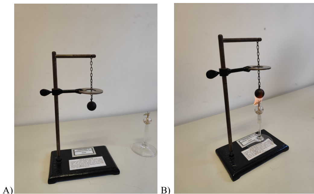
Figura 4: A: Esfera antes de ser aquecida ; B: Esfera sendo aquecida.
