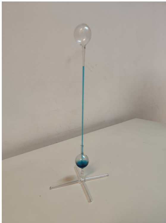
Figura 1: Aparato experimental do termoscópio de Galileu.
