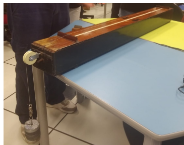
Figura 5. Fotografia da montagem utilizada no laboratório para investigar os modos de vibração de uma corda tensionada. A tensão é aplicada com o uso de massas e o comprimento pode ser ajustado. Fonte: autoria própria.
