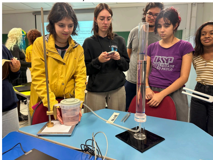
Figura 1: Sistema formado para a variação da coluna de água presente no tubo fechado por meio da variação de altura de uma
