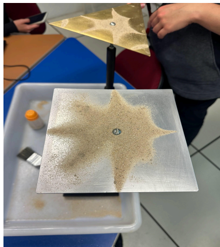
Figura 4: Padrões visuais resultados da vibração da placa de metal.
