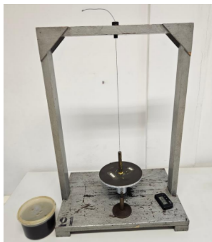
Figura 3: Materiais utilizados: pêndulo de torção, recipiente contendo óleo e cronômetro. Fonte: Fotografia tirada pelo monitor Pedro
