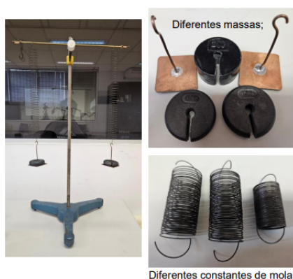
Figura 1: A esquerda, o sistema massa–mola com as massas acopladas à extremidade inferior da mola, a direita, jogo de molas, pesos e suportes utilizados no experimento. Fonte: Fotografias tiradas pelo monitor Pedro
