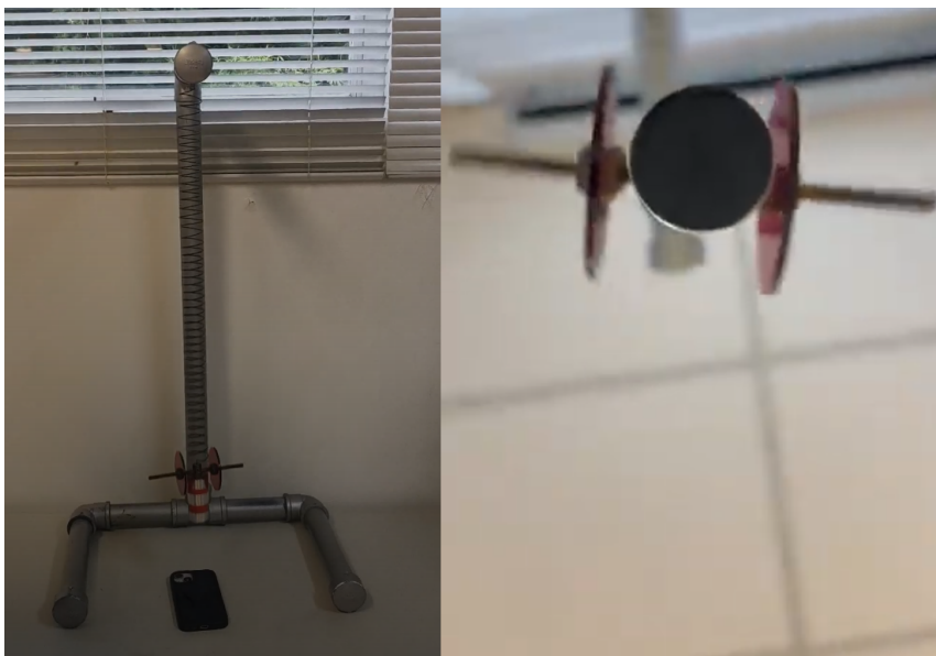
Figura 2 - Pêndulo de Wilberforce em repouso visto de frente (à esquerda) e por baixo (à direita).
