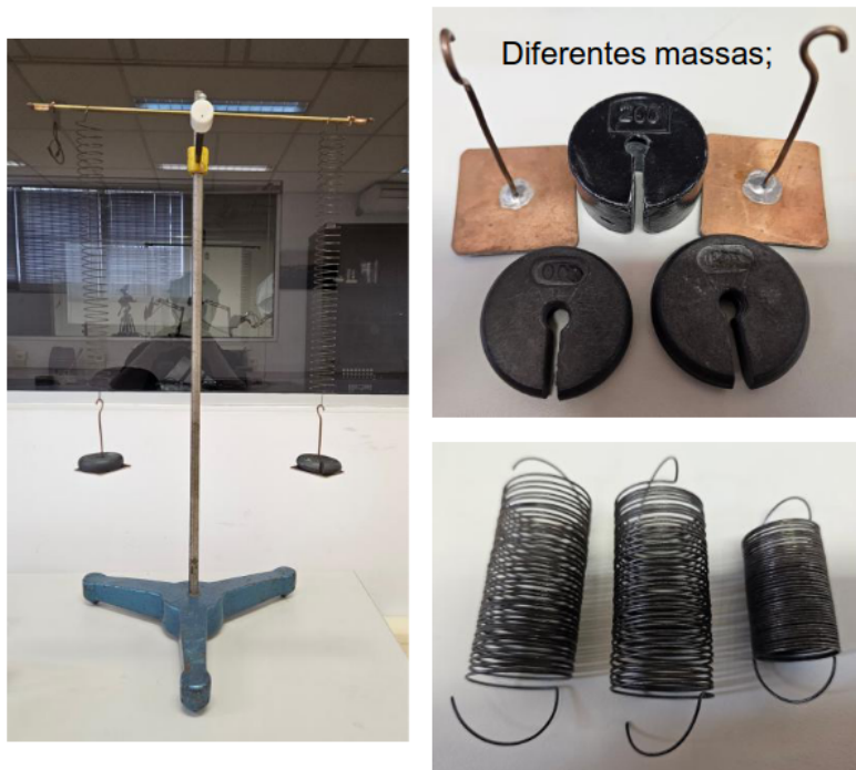
Figura 2: Arranjo experimental utilizado no experimento massa-mola.
