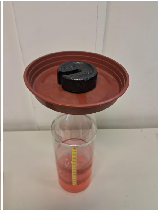
Imagens 3.2.3 e 3.2.4: medida apresentada pela balança (525g) e peso posicionado no prato da balança, respectivamente.
