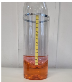
Figura 3: Medida da massa de um objeto na balança de empuxo
