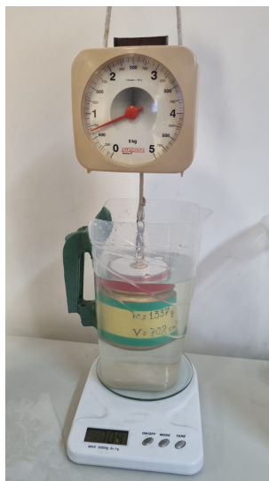
Figura 2: Cilindro suspenso em dinamômetro e submerso em água sobre balança digital
