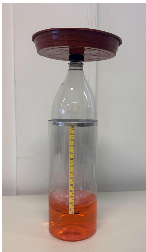
Figura X: Sistema formado pelo recipiente com o fluido e o corpo ‘garrafa + prato’.
