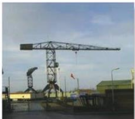
Exemplos de treliças aplicadas na construção de guindastes e megaestruturas. Fonte [1,2].
