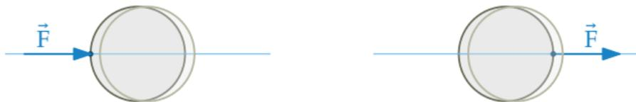
Efeitos da aplicação de duas forças de *mesmas intensidade, direção, orientação e linha de ação*, porém em pontos distintos de um *corpo rígido*.
