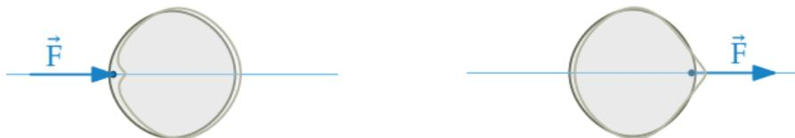
Efeitos da aplicação de duas forças de *mesmas intensidade, direção, orientação e linha de ação*, porém em pontos distintos de um *corpo deformável*.
