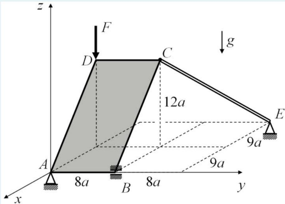
**a) (1,5 ponto)** Determine o **módulo** da força que a barra  $CE$  aplica na placa, e escreva o valor no campo a seguir, com até uma casa decimal e **use PONTO como separador**;
