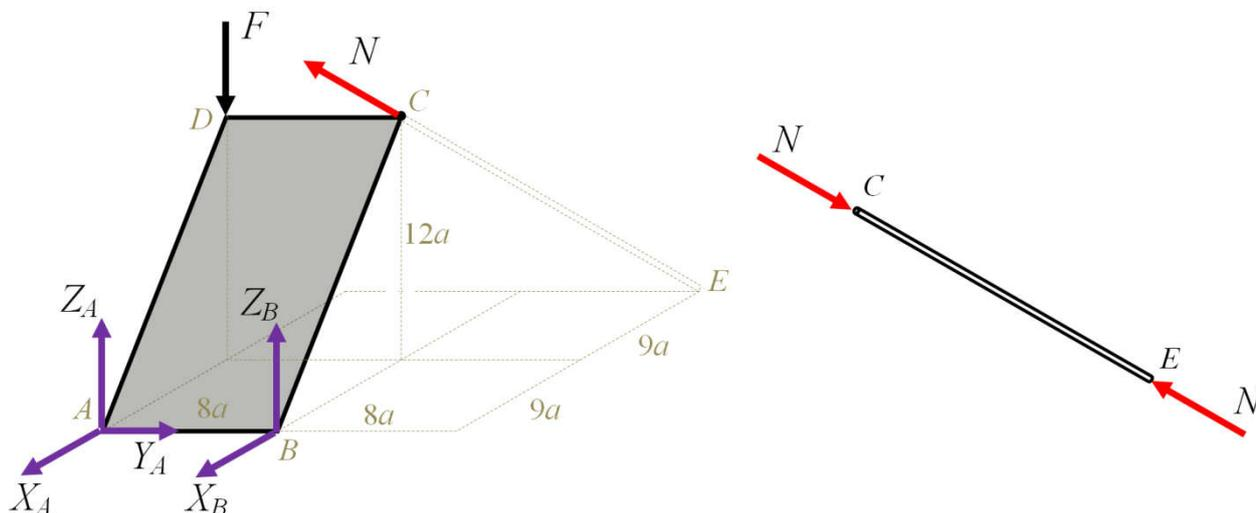
Notando que a barra  $CE$  é uma barra de treliça, a força  $\vec{N}$  tem a direção de  $(C - E)$ :
