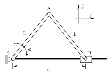
c) Determinar a aceleração do ponto A, a aceleração angular  $\dot{m{w}}_{AB}$  da barra AB e a aceleração do ponto B.
