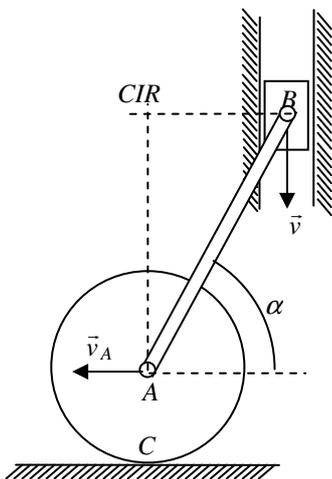
Portanto são conhecidas as direções das velocidades dos pontos  $A$  e  $B$  da barra  $AB$ . O CIR da barra  $AB$  é determinado a partir da construção geométrica indicada na figura ao lado.
