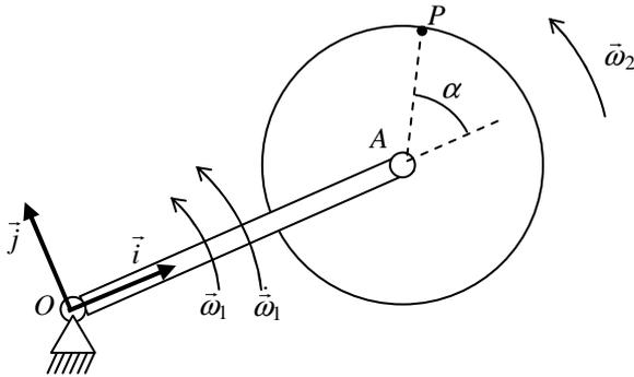
**1ª Questão (3,5 pontos).** Em um dado instante, a haste  $OA$ , de comprimento  $L$ , tem velocidade angular  $\omega_1$  e aceleração angular  $\dot{\omega}_1$ . Em sua extremidade  $A$  está articulado um disco de raio  $R$ , o qual gira com velocidade angular  $\omega_2$  constante em relação à haste. Adotando a haste como referencial móvel, pede-se determinar:
