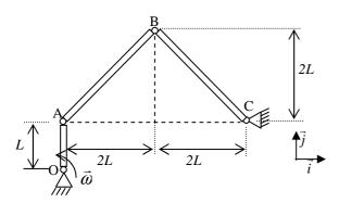
**QUESTÃO 1 (3 pontos):** No mecanismo plano de 3 barras indicado na figura, a barra AB está articulada por meio de pinos à barra OA, que gira com velocidade angular  $\omega$  constante em torno do ponto O fixo, e à barra BC, que gira em torno do ponto C fixo. Para a configuração indicada, em que a barra OA tem a direção do versor j, determinar:
