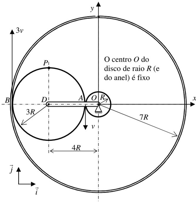
**2ª Questão (3,5 pontos)** – A figura mostra um disco de centro  $D$  e raio  $3R$  em contato sem escorregamento com um disco de raio  $R$  e centro  $O$  e um anel de raio  $7R$ , de centro  $O$ . A barra  $OD$  une os centros  $D$  e  $O$  por meio de articulações. **No instante mostrado na figura**, o ponto  $A$  do disco de raio  $R$  tem velocidade  $\vec{v}_A = -v \vec{j}$ , e o ponto  $B$  do anel tem velocidade  $\vec{v}_B = 3v \vec{j}$ , com  $v$  conhecida e constante.
