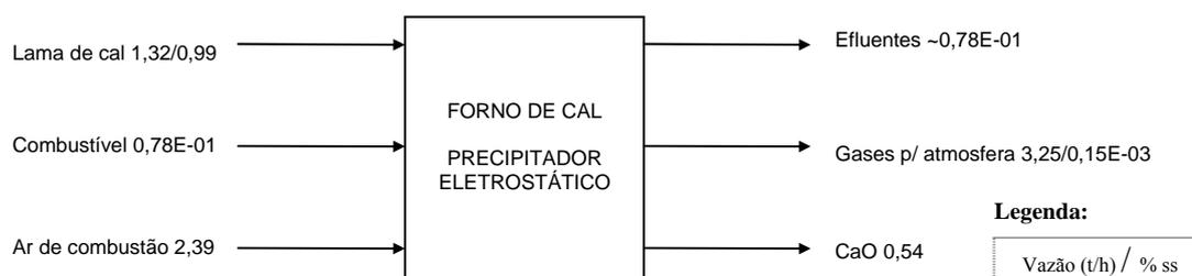
**Figura 28:** Balanço de massa para o subsistema constituído pelo forno de cal e precipitador eletróstático (adaptado de PECE/USP, 2005)
