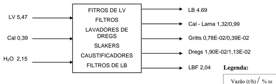
**Figura 27:** Balanço de massa consolidado para algumas unidades de processo da caustificação (adaptado de PECE/USP, 2005)
