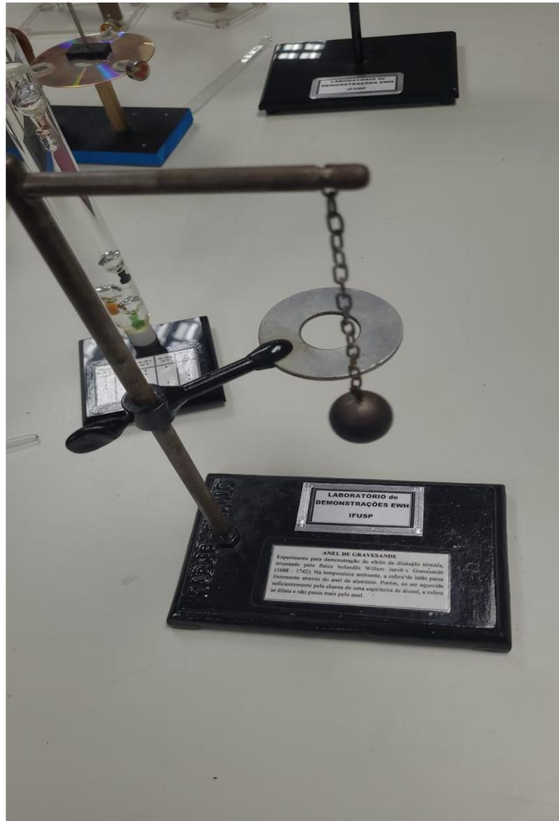
**Consiste em um anel metálico com uma pequena folga entre suas extremidades. Quando aquecido, o anel se expande de forma que a folga entre as extremidades desaparece.**
