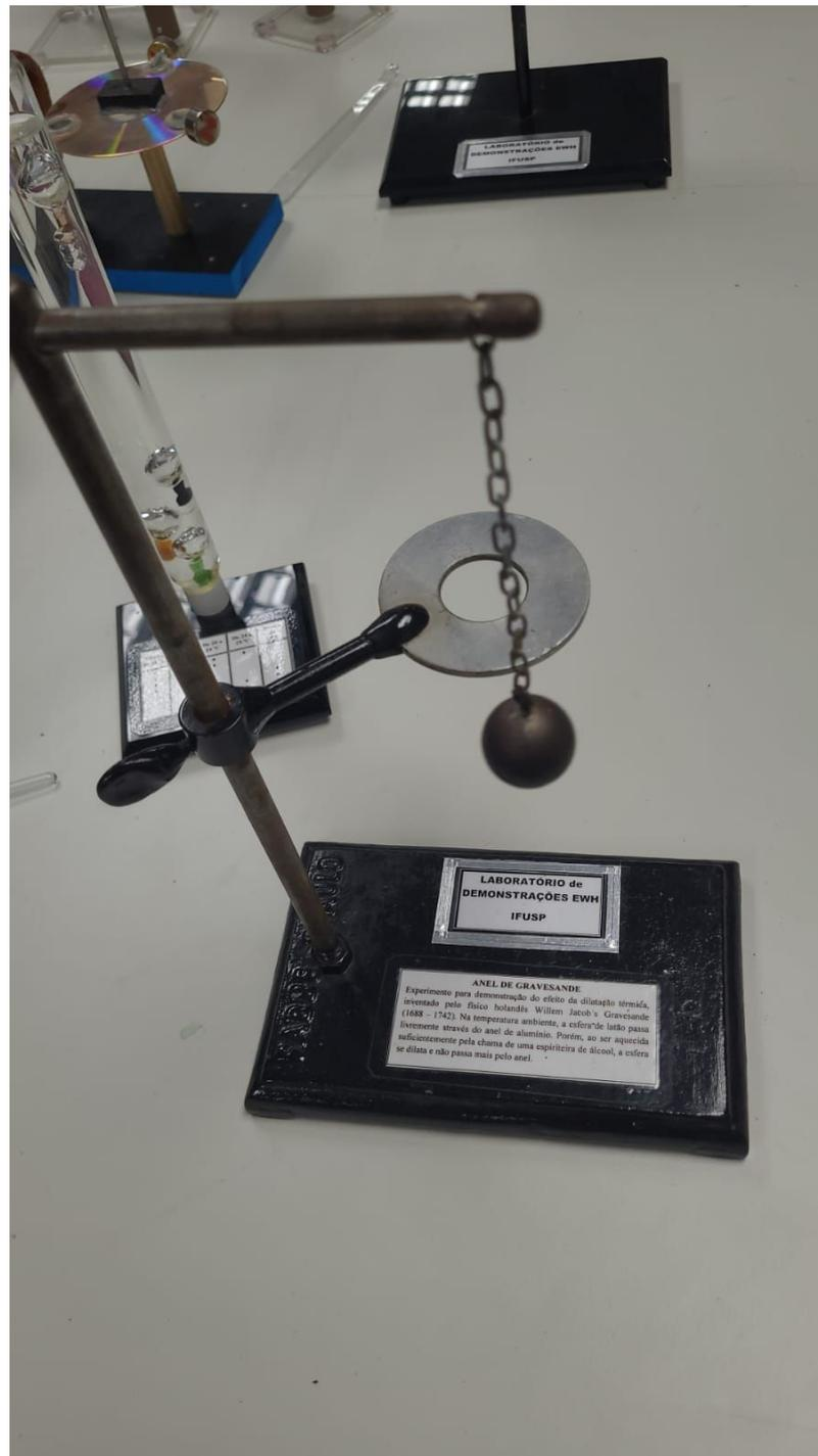
Consiste em um anel metálico com uma pequena folga entre suas extremidades. Quando aquecido, o anel se expande de forma que a folga entre as extremidades desaparece. Essa aparente magia é explicada pela dilatação térmica do metal. Quando o anel é aquecido, suas moléculas se agitam mais rapidamente, resultando em um aumento do espaçamento intermolecular e, portanto, em uma expansão do próprio anel.
