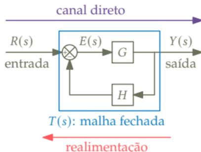
Dizemos que um sistema SISO de ordem  $n$  (com  $n = m + r$ ) é do *tipo*  $m$  quando sua *função de transferência de malha aberta* tem a forma:
