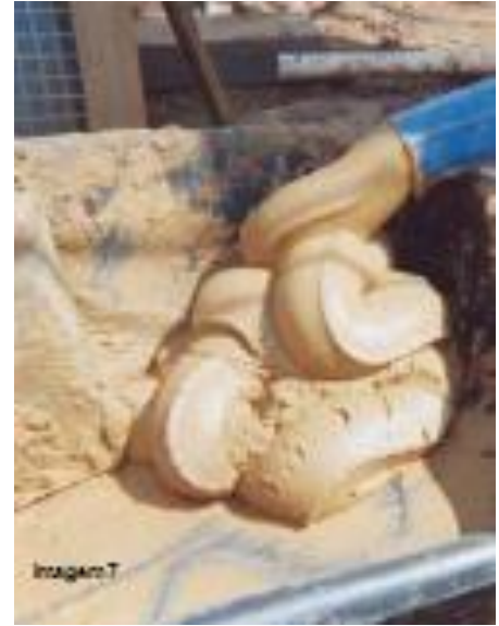
Figura 2 (fonte: Rocha, 2008). Separação catiônica de finos da mineração de ferro.
