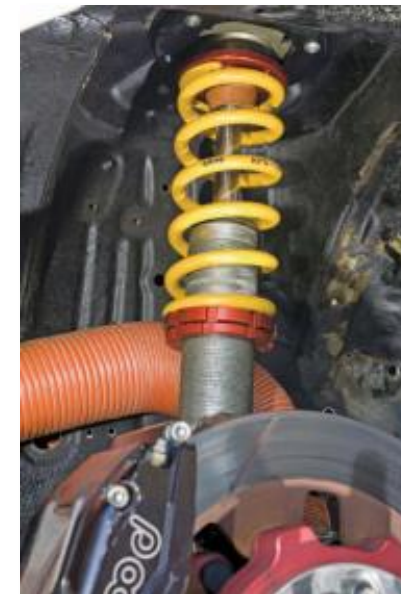
Suspensão de um automóvel. As molas e amortecedores que compõem o sistema devem ser cuidadosamente selecionados para proporcionar dirigibilidade. Fonte [1].
