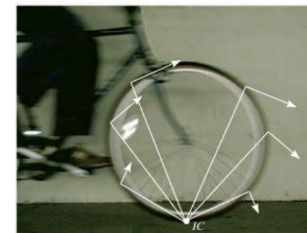
Centro instantâneo de rotação de campo de velocidades de uma roda de bicicleta. Fonte: [2]
