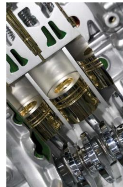
Sistema pistão-biela-manivela de um motor de combustão interna. Fonte [3].
