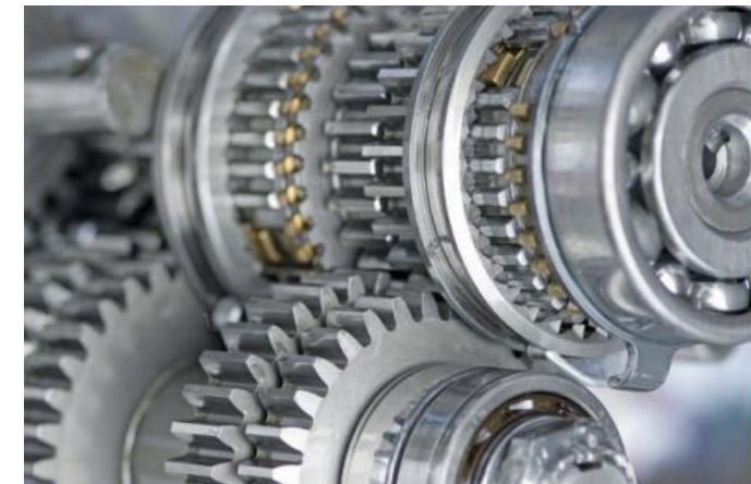
Exemplos de sistemas em que a hipótese de corpo rígido é aceitável para a análise dos movimentos globais associados. Fonte [1].
