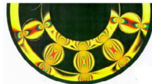
Franjas isocromáticas dos contatos esferas/pista de um mancal de rolamentos. As franjas representam a intensidade das tensões de contato.
