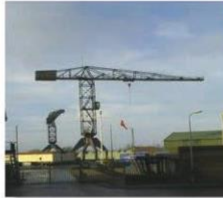
Exemplos de treliças aplicadas na construção de guindastes e megaestruturas. Fonte [1,2].
