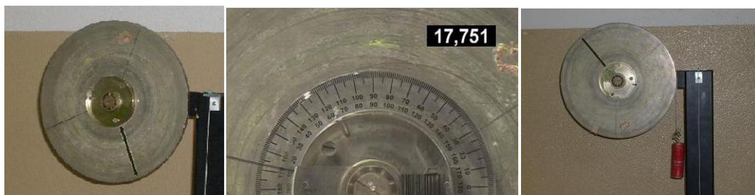
Figura 2. Da esquerda para a direita: roda de inércia, transferidor e peso pendurado à roda de inércia.
