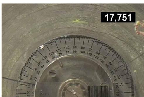
Figura 2: Objeto que possibilita a aferição do ângulo o qual a roda de inércia girou.
