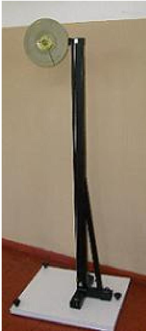
Figura 3: Objeto ao qual é fixado a roda de inércia, sendo o mesmo fixo na base de madeira.
