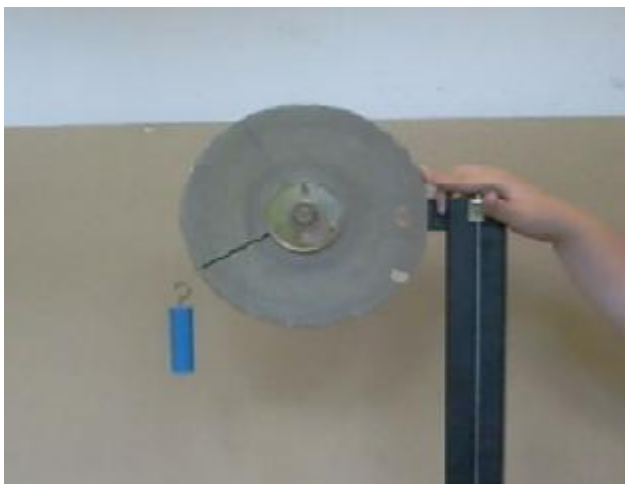
Foto 1: Disco de inércia, com peso pendurado
