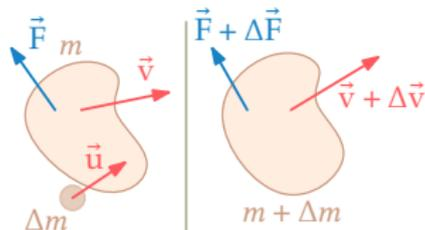
No instante de tempo  $t_0 + \Delta t$  há uma única partícula material de massa  $m + \Delta m$  com velocidade  $\vec{v} + \Delta\vec{v}$ .
