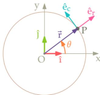
Isto motiva a definição da *velocidade angular*  $\omega = \dot{\theta}$  e da *aceleração angular*  $\alpha = \ddot{\theta}$ .
