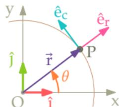
Um sistema descreve um **movimento de corpo rígido** se *qualquer* par de pontos neste sistema *preservar constante sua distância relativa*. Dados dois pontos P e Q quaisquer solidários a um corpo rígido, os vetores de *posição relativa*,  $(P-Q)$ , e *velocidade relativa*,  $\vec{v}_{P/Q} = \vec{v}_P - \vec{v}_Q$ , são ortogonais entre si, conforme a *equação característica*:
