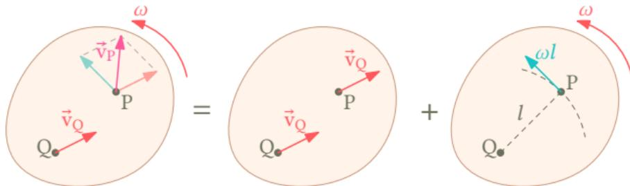
Graficamente, o movimento plano de corpo rígido é a composição de uma translação com velocidade  $\vec{v}_Q$  e uma rotação em torno de um ponto Q do corpo.
