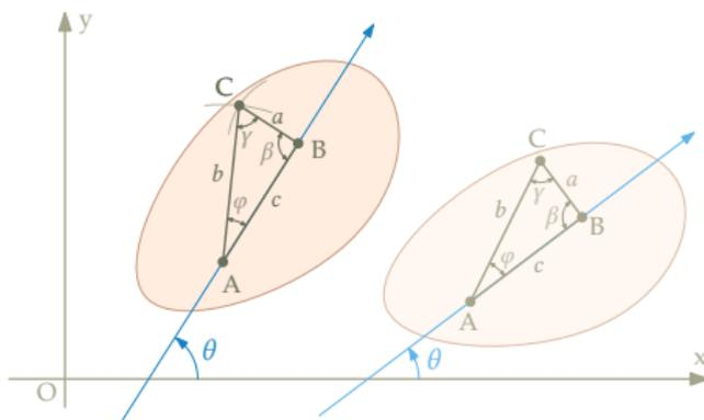
Um sistema descreve um **movimento de corpo rígido** se *qualquer* par de pontos neste sistema *preservar constante sua distância relativa*.
