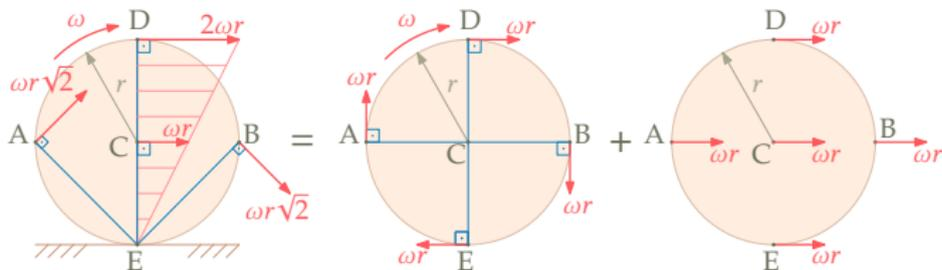
No exemplo acima, vemos um disco que rola sem escorregar sobre uma superfície plana fixa. Neste caso, o ponto E tem *velocidade nula* e é *CIR* do disco. Note que este movimento pode ser melhor compreendido como a *composição* de uma *rotação em torno do centro C* com uma *translação* da roda. Já no exemplo ao lado, o CIR do disco é o ponto I indicado.
