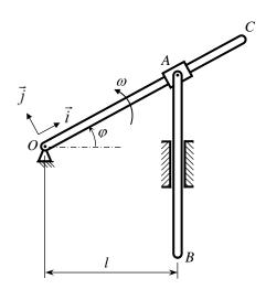
velocidade angular  $\omega$  constante. O anel A escorrega sobre a barra OC e a barra AB, articulada no anel, tem liberdade de movimento apenas na vertical. Pede-se calcular a velocidade relativa de A com respeito à barra OC.
