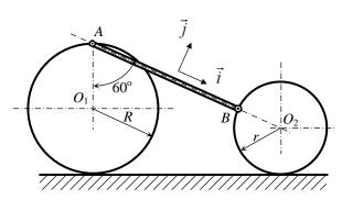
$\vec{\Omega} = \Omega \vec{k}$ ,  $(\Omega > 0, \vec{k} = \vec{i} \wedge \vec{j})$ . Nesse instante a barra AB, cujas extremidades são articuladas a dois pontos na periferia dos discos, ocupa a posição indicada, na qual A, B e  $O_2$  estão alinhados. Pedem-se nesse instante, em função das constantes. R,  $r \in \Omega$ , expressando os vetores na base  $(\vec{i}, \vec{j}, \vec{k})$ :
