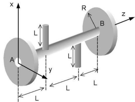
**2ª Questão (4,0 pontos):** O mecanismo da figura é constituído por duas barras delgadas idênticas, de massa  $m$  e comprimento  $L$  cada uma, e por um disco de massa  $M$  e raio  $R$ . O sistema é solto do repouso a partir da configuração mostrada na figura. O disco rola sem escorregar sobre a superfície. Com base nestas informações, pedem-se:
