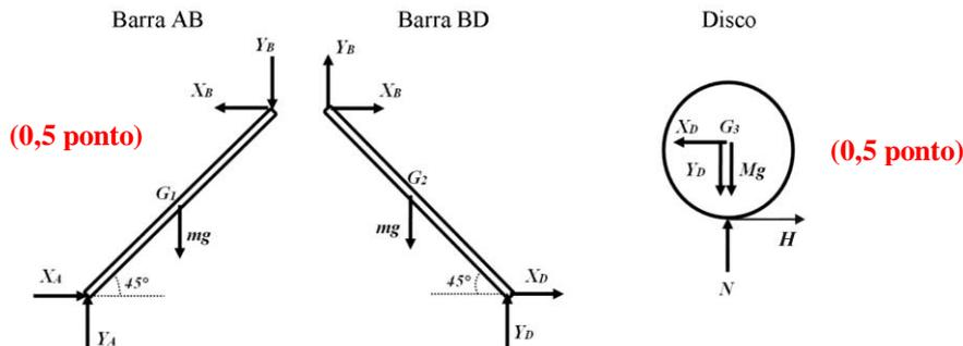
b) Considerando o sistema formado pelas duas barras e o disco, as forças internas não realizam trabalho (ação e reação, forças conservativas). As únicas forças que realizam trabalho são os pesos das barras, aplicados em  $G_1$  e  $G_2$ , respectivamente:
