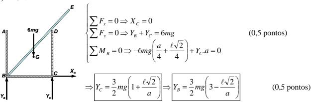
c) O sistema deixa de estar em equilíbrio quando a coordenada  $x_G$  do baricentro é suficientemente elevada para causar a rotação em torno do ponto C. Isso ocorre pois o vínculo B é incapaz de restringir o movimento no sentido positivo de y. Assim, para haver equilíbrio é necessário que  $Y_B \ge 0$ , ou seja, (0,5) pontos a explicação acima)
