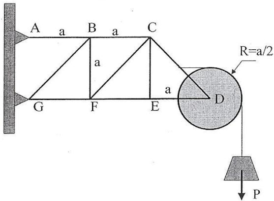
Na estrutura plana, mostrada na figura, A, B, C, D, E, F e G são articulações. Os pesos das barras e das polias podem ser desprezados. Pede-se:
