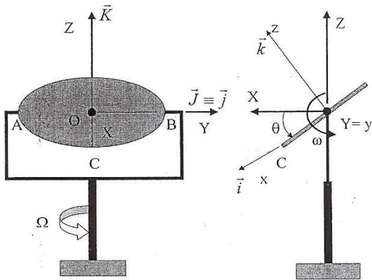
A figura mostra um disco homogêneo, de raio  $R$ , que pode girar em torno do eixo AB ( $OY \equiv Oy$ ), com velocidade angular  $\vec{\omega} = \omega \hat{j}$ . O garfo (referencial móvel) está preso a um eixo vertical que gira com velocidade angular  $\vec{\Omega} = \Omega \hat{k}$ .
