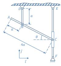
e ao ponto B da barra AC, estando a extremidade C desta barra articulada a uma luva restrita a deslizar com velocidade  $v\vec{j}$  constante e conhecida sobre o eixo vertical fixo EF. Para o instante em que a barra BD se encontra na vertical, pede-se, em função do ângulo  $\theta$  entre a barra AC e a horizontal:
