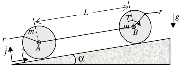
**3ª Questão (3,5 pontos).** Dois cilindros iguais de raio  $r$  e massa  $m$ , interligados por meio de articulações a um cabo inextensível  $AB$  de comprimento  $L$  e massa desprezível, sobem uma rampa de inclinação  $\alpha$  sob a ação de um torque  $T$  aplicado ao cilindro dianteiro. Admitindo-se que ambos os cilindros rolem sem escorregar e que o coeficiente de atrito entre eles e a rampa seja  $\mu$ , pede-se:
