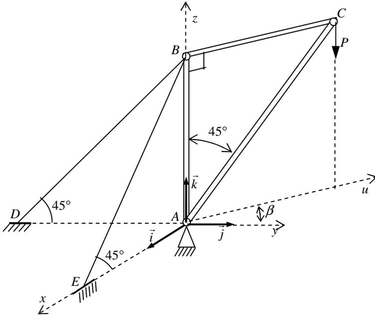
**1ª Questão (3,5 pontos).** O quadro  $ABC$ , com a forma de um triângulo retângulo isósceles, é constituído por três barras articuladas entre si e de peso desprezível. O quadro é articulado em  $A$  e ligado em  $B$  a dois cabos  $BD$  e  $BE$  inclinados de  $45^\circ$  com a vertical, conforme indicado na figura. O plano  $ABC$  forma um ângulo  $\beta$  ( $0 \leq \beta \leq 90$ ) conhecido com o plano  $yz$ . Em  $C$  aplica-se uma carga vertical  $P$ . Pede-se:
