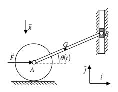
**QUESTÃO 3 (3,0 pontos).** Uma barra AB de massa m e comprimento  $\ell$  tem suas extremidades articuladas a um disco de massa M e raio R e a um pistão de massa desprezível. No estado em que a barra forma um ângulo  $\theta$  com a horizontal, o sistema é mantido em equilíbrio mediante a aplicação de uma força  $\vec{F}_1 = mg \frac{\ell}{2} \cot \theta \vec{i}$  à articulação A. Repentinamente, aumentando-se
