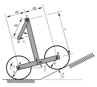
QUESTÃO 2 (3,5 pontos). A barra rígida ABC é conduzida por meio dos discos de raio R cujos centros estão nas articulações A e B. Os discos rolam sem escorregar com velocidade angular constante de módulo \$\omega\$1 sobre as superfícies planas horizontal (disco A) e inclinada (disco B). No instante mostrado, a barra rígida CD possui velocidade angular constante de módulo \$\overline{\theta}\$ = \$\omega\$2 em relação ao corpo ABC, e o ângulo formado entre o segmento AB e a horizontal é
