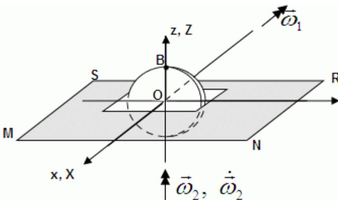
O eixo  $Ox$  é fixado na placa  $MNRS$  que, por sua vez, possui rotação  $\vec{\omega}_2$  e aceleração rotacional  $\dot{\vec{\omega}}_2$ . O sistema de referência  $Oxyz$  é solidário à placa  $MNRS$ ; o sistema de referência  $OXYZ$  é fixo (inercial) e, no instante mostrado, seus eixos coincidem com os do sistema  $Oxyz$ . Nessas condições pedem-se:
