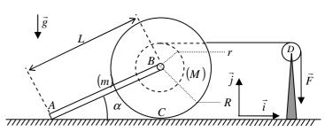
horizontal, arrastando consigo a barra AB. A polia de centro D tem massa desprezível e o coeficiente de atrito entre as superfícies da barra AB e a do plano horizontal é  $\mu$ . C é o ponto de contato do carretel com o plano horizontal. O momento de inércia do carretel em relação ao eixo Bz é dado:  $J_{Bz} = J$ . Pedese:
