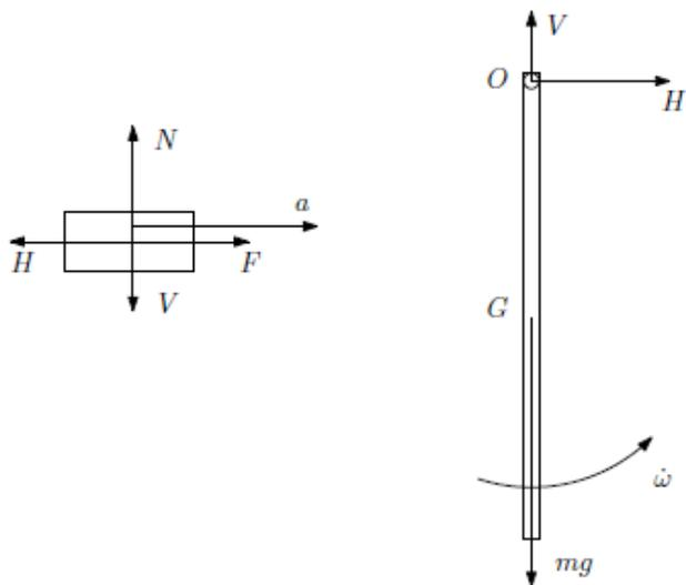
Figura 1: Diagramas de corpo livre e orientação das acelerações
