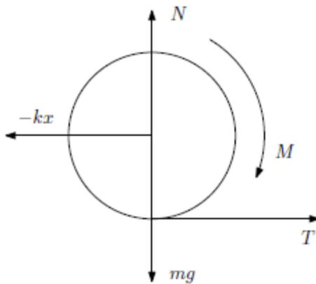
Figura 2: Diagrama de corpo livre do disco
