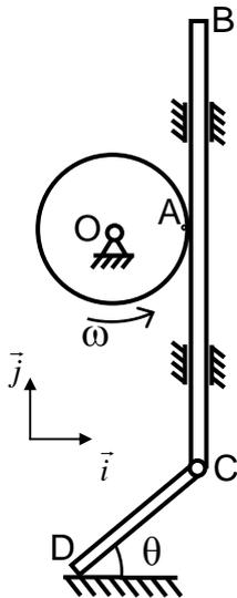
**2ª Questão (3,5 pontos).** No sistema mostrado na figura, o disco de centro fixo  $O$  tem raio  $R$  e vetor de rotação  $\vec{\omega} = \omega \vec{k}$ , constante. O disco rola sem escorregar em relação à barra  $BC$ , que tem liberdade para mover-se verticalmente. A barra  $CD$  tem comprimento  $L$ , está articulada em  $C$  e desliza no ponto  $D$ , mantendo contato com a superfície horizontal.
