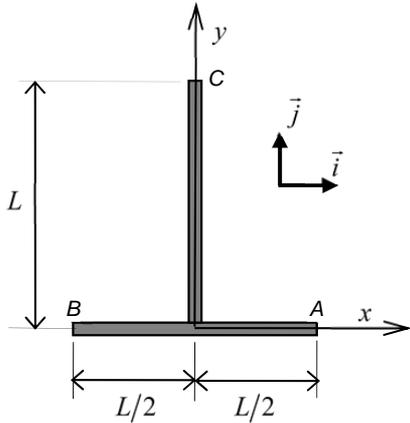
**QUESTÃO 1 (3,0 pontos).** A peça  $ABC$  mostrada na figura é formada por dois segmentos ortogonais de comprimento  $L$ . Em um dado instante, sabe-se que as velocidades dos pontos  $A, B$  e  $C$  são:
