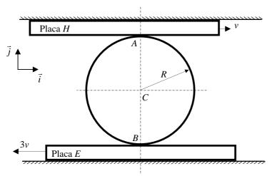
QUESTÃO 2 (3,5 pontos) – A figura mostra um disco de centro C e raio R entre duas placas paralelas entre si. A placa H translada com velocidade  $\vec{v}_H = v\vec{i}$ , constante, e a placa E translada com velocidade  $\vec{v}_E = -3v\vec{i}$ , constante.
