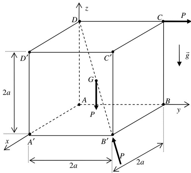
**1ª Questão (3,0 pontos).** O cubo homogêneo  $ABCA'B'C'D'$ , de lado  $2a$  e peso  $P$ , está sujeito ao sistema de forças indicado na figura ao lado. Utilizando a base de versores  $\vec{i}, \vec{j}, \vec{k}$ , referentes aos eixos  $x, y, z$ , respectivamente, pede-se:
